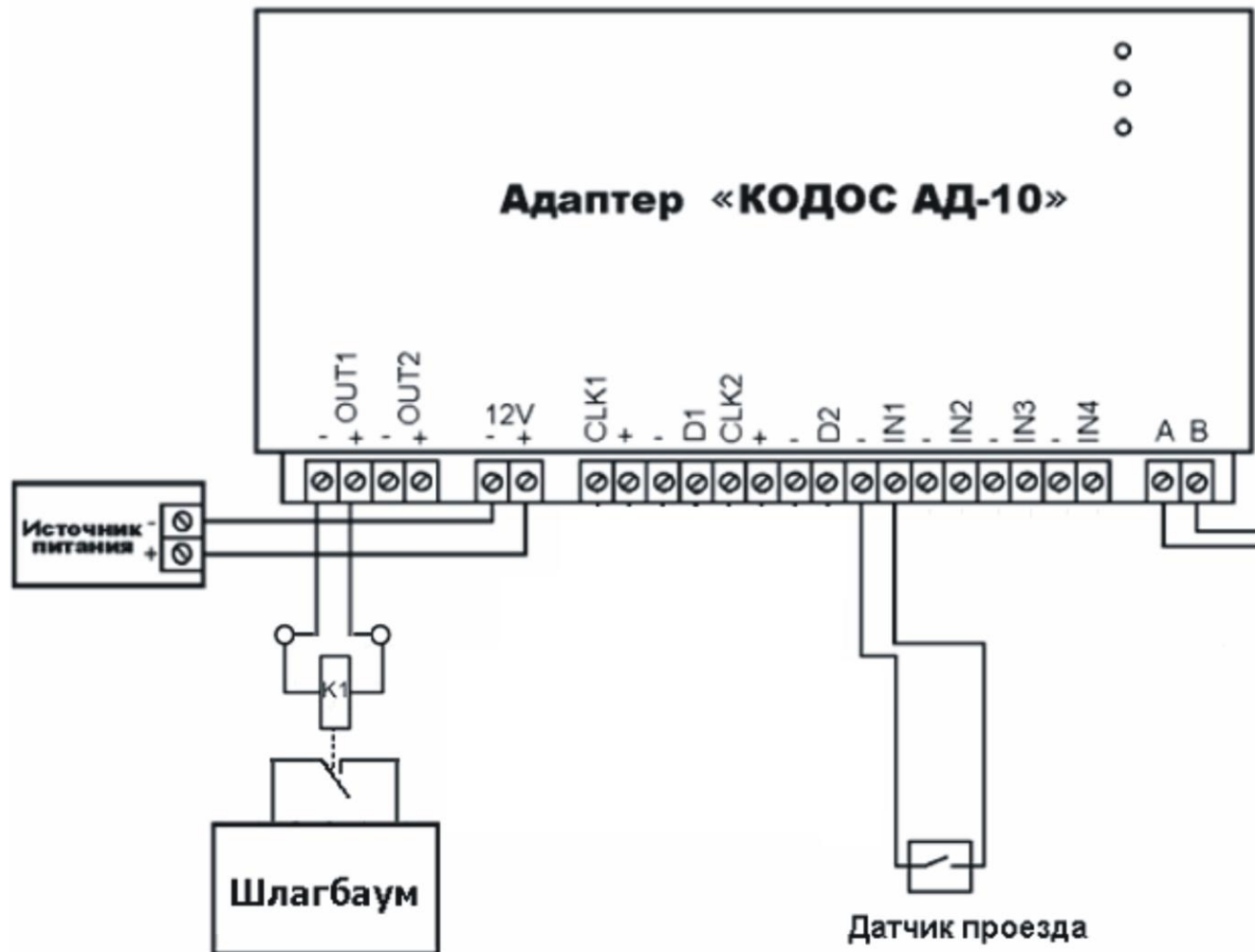
Рис. 3.2. Подключение контроллера АД-10 к шлагбауму. Вариант управления 2
