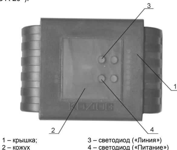
Рисунок 1 – Внешний вид адресного блока «КОДОС А-07/4»
