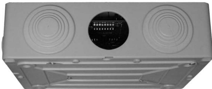
Рисунок 9 – Расположение DIP-переключателей контроллера
