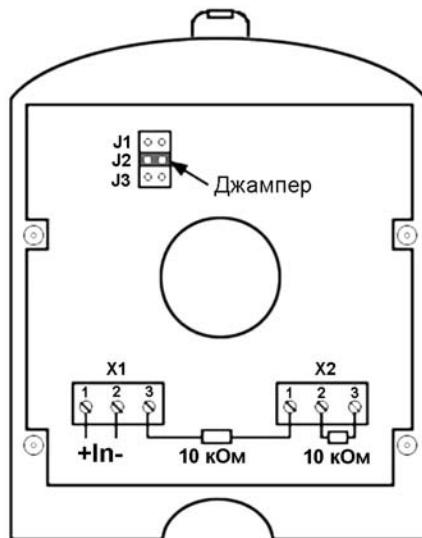
Рисунок 40 – Установка джампера и резисторов извещателя ИПР-ЗСУ
