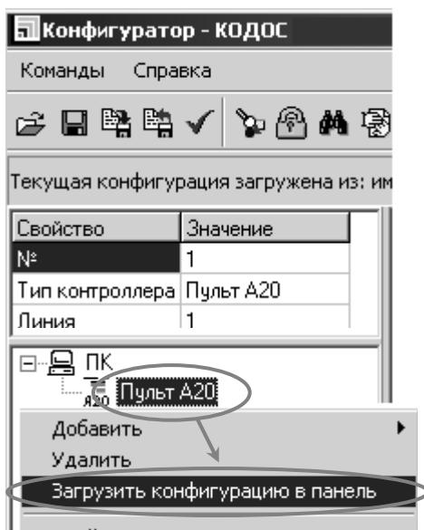
Рисунок 70 – Загрузка конфигурации
