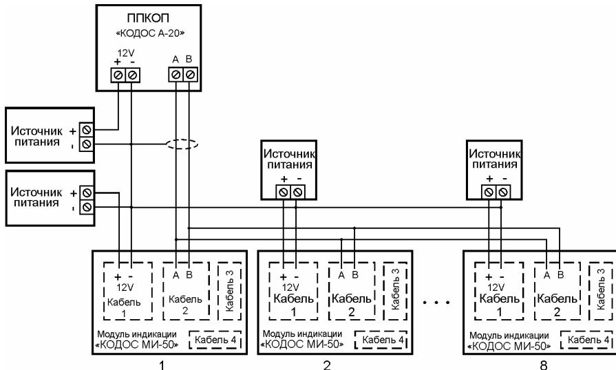
**Рисунок 28 – Подключение к прибору А-20 нескольких МИ-50**
