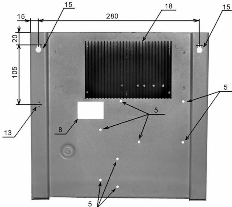
5 – отверстия под ограничительные стойки      15 – крепежные отверстия
