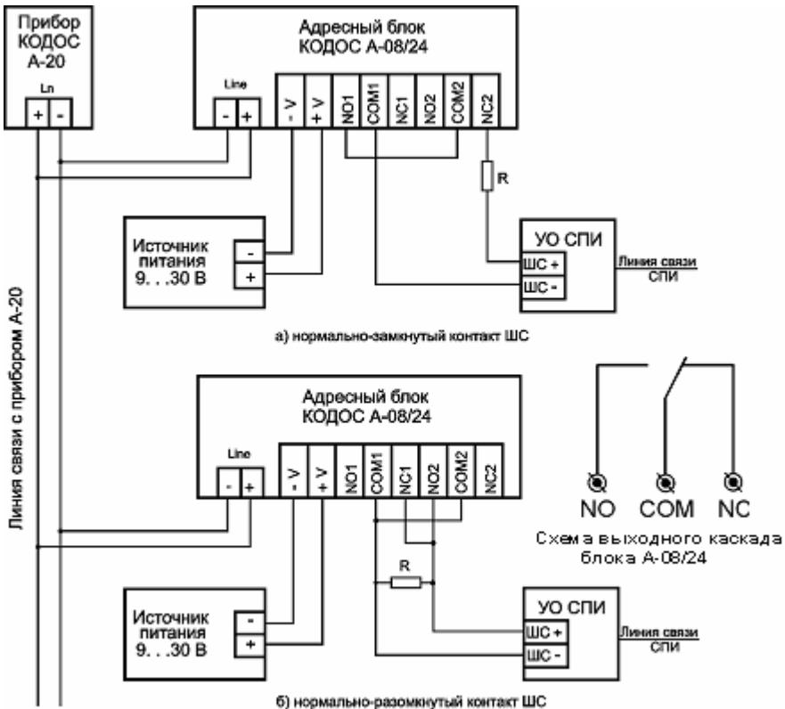
**Рисунок 6 – Схема подключения к СПИ через «КОДОС А-08/24»**
