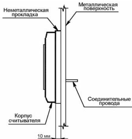
Рисунок 30 – Установка считывателя на металлическую поверхность
