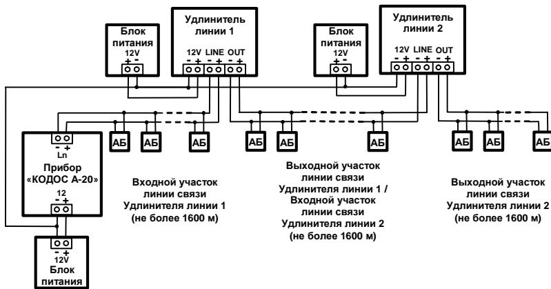
**Рисунок 23 – Схема подключения удлинителей линии «КОДОС УЛ-01»**
