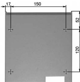
**Рисунок 3 – Расположение отверстий для крепления прибора А-20**
