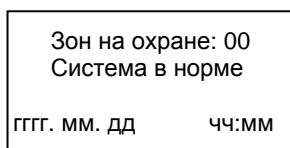
где гггг.мм.дд – дата, чч:мм - время. Дата и время могут не совпадать с реальными, их установка производится при дальнейшей настройке прибора А-20.
