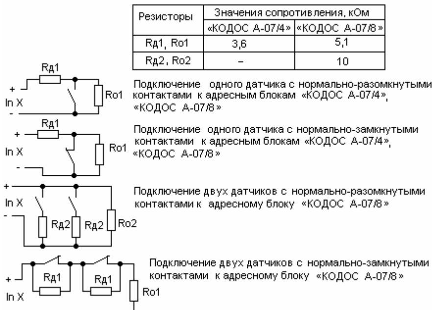
**Рисунок 13 – Схемы подключения контролируемого шлейфа к адресным блокам «КОДОС А-07/4» и «КОДОС А-07/8»**
