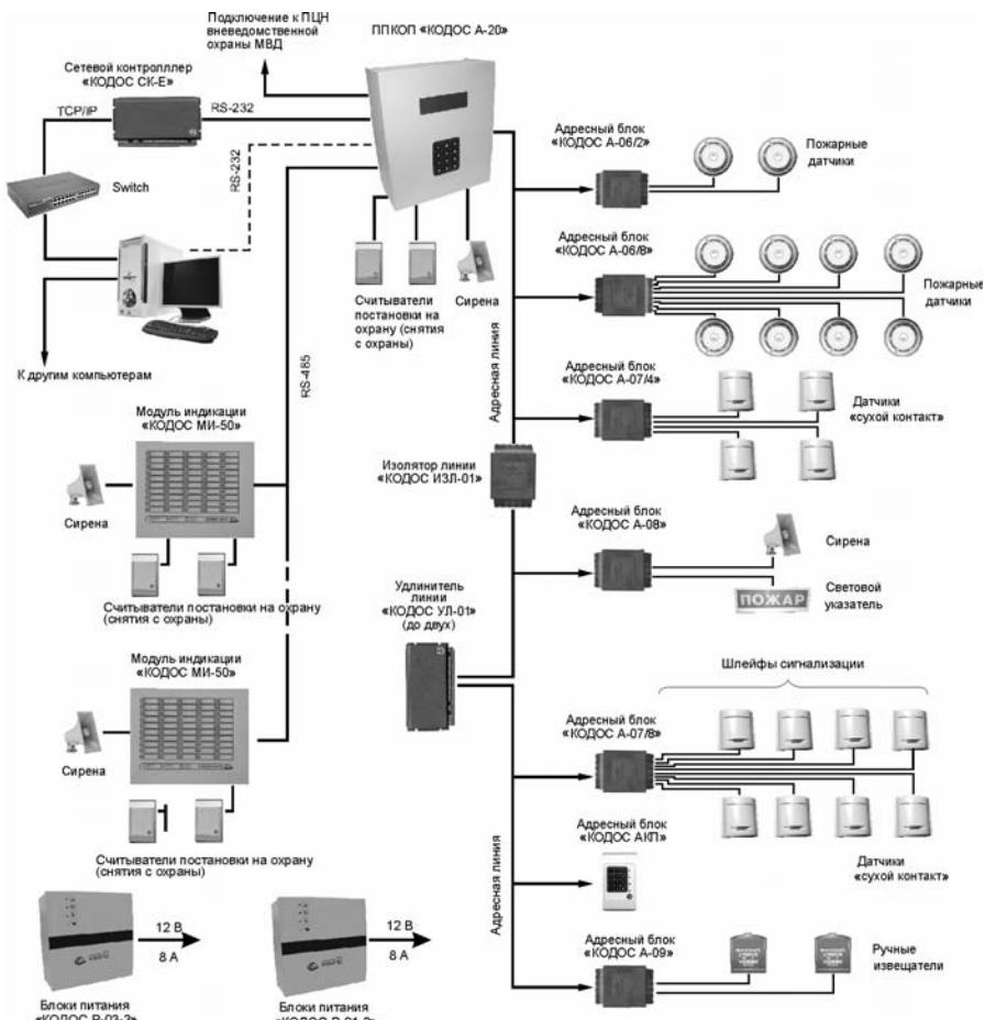
**Рисунок 1 – Структурная схема адресной системы ОПС**
