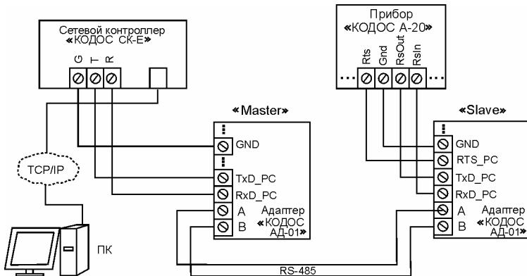
Рисунок 36 – Подключение к сетевому контроллеру прибора А-20 через адAPTERЫ «КОДОС АД-01»
