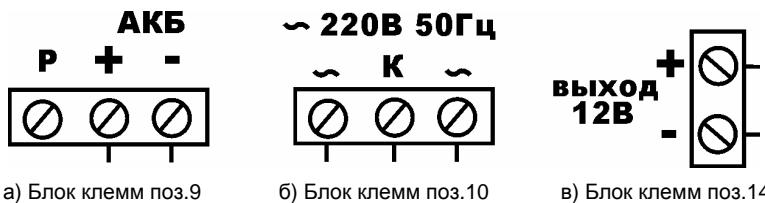
**Рисунок 39 – Маркировка блоков клемм ББП**
