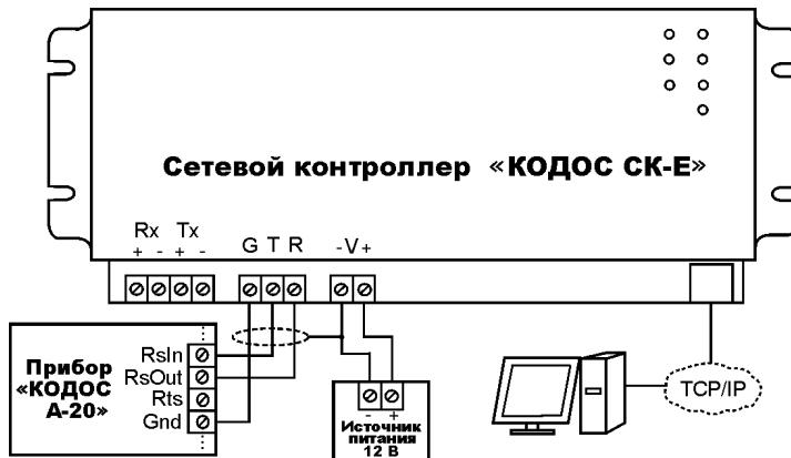
Рисунок 35 – Подключение сетевого контроллера к прибору А-20
