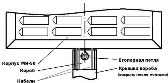
Рисунок 26 – Монтаж МИ-50 и короба с проводкой
