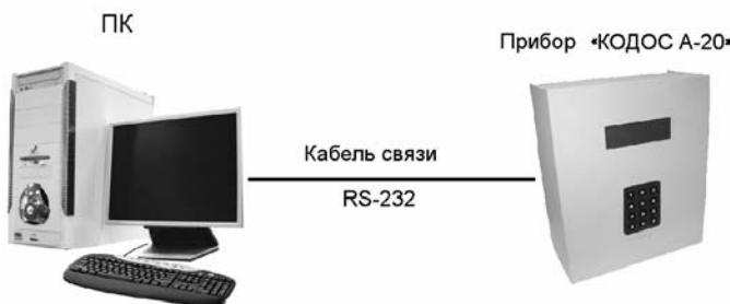
Рисунок 5 – Подключение прибора А-20 к ПК
