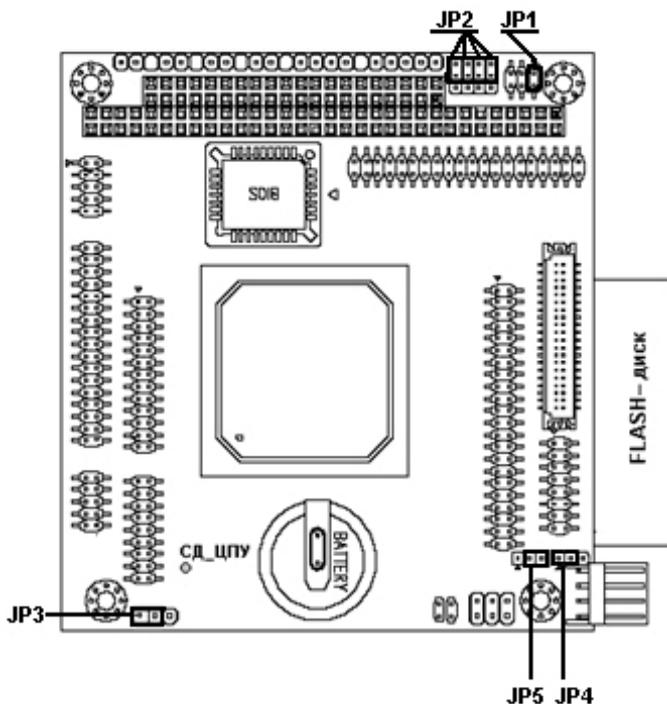
Рисунок 6 – Расположение джамперов на блоке ЦПУ
