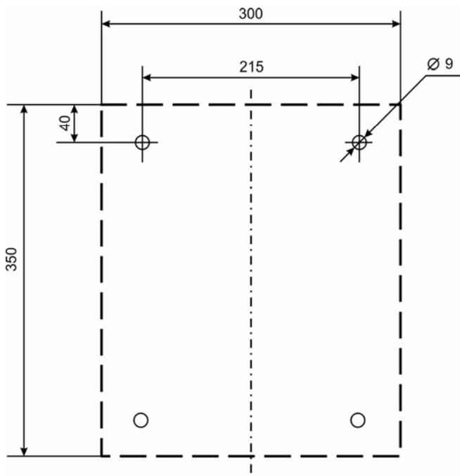
**Рисунок 5 – Крепление контроллера (размеры приведены в миллиметрах)**
