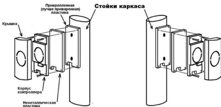
Рисунок 20 – Установка контроллера на общий каркас
