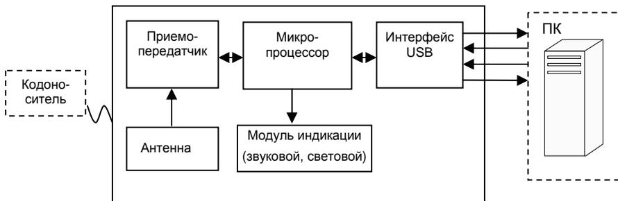
Рисунок 4 – Функциональная схема, поясняющая работу считывателя
