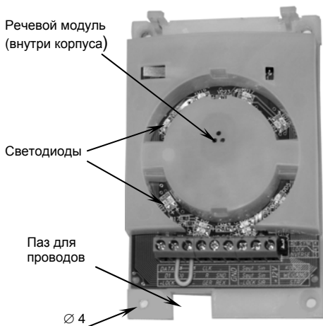
Рисунок 8 – Вид считывателя без крышки и уплотнительного кольца
