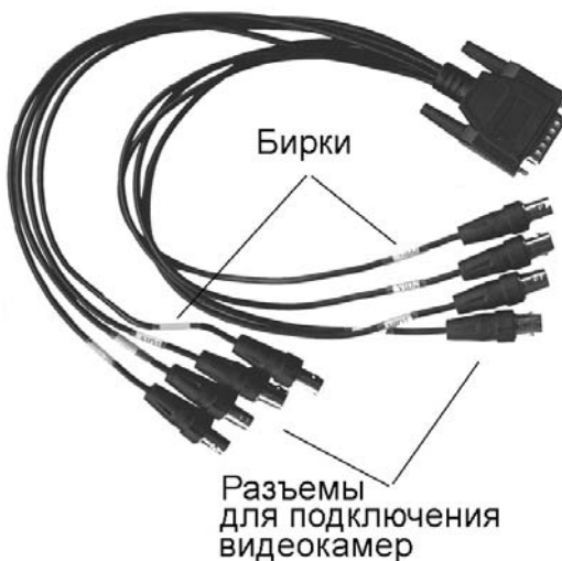
Рисунок 3 – Кабель видеоввода для подключения видеокамер
