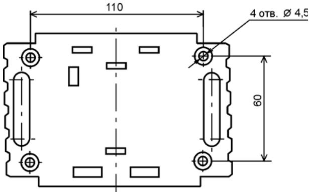
Рисунок 5 -- Крепление изолятора линии (присоединительные размеры)
