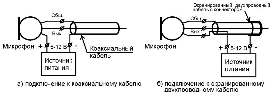
Рисунок 4 – Способы подключения микрофонов
