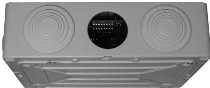
Рисунок 9 – Расположение DIP-переключателей контроллера
