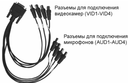
Рисунок 2 – Кабель видео/аудиоввода для подключения видеокамер и микрофонов
