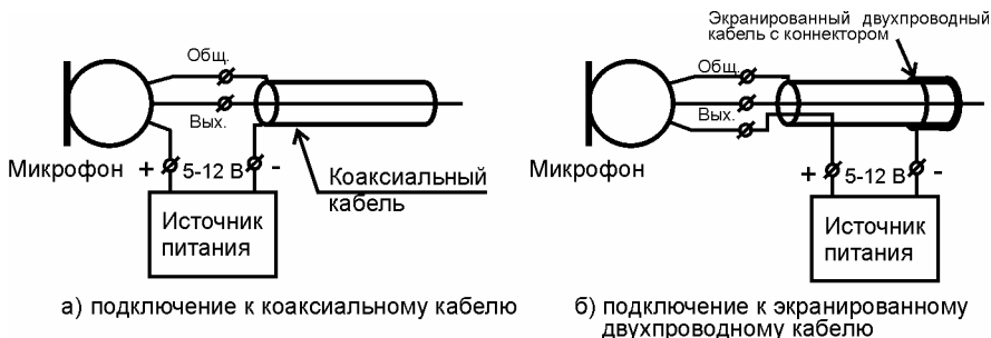
Рисунок 4 – Способы подключения микрофонов
